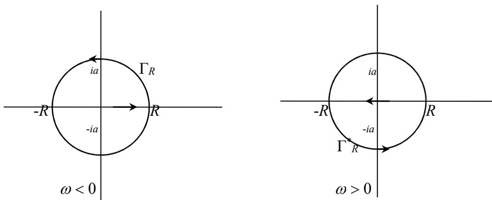
Para  $\omega < 0$ , integrando  $h$  en el intervalo real  $[-R, R]$  y en la semicircunferencia superior indicada en la figura, con  $R > a$ , se tiene (Teorema de los Residuos)
